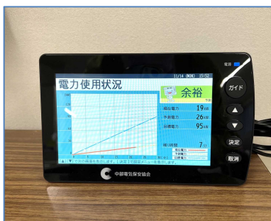
デマンド監視システム
